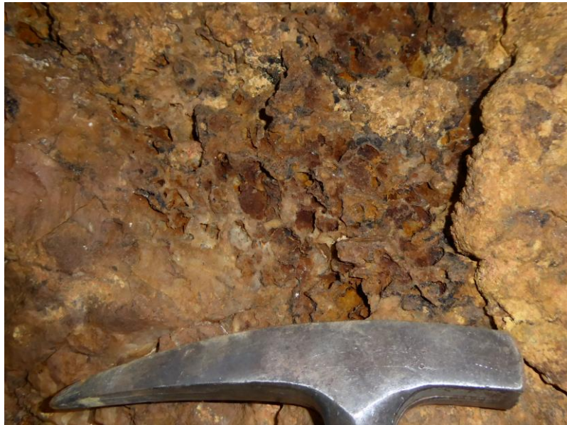
Figura 5. 2 - Fotografia de material goethítico formando boxwork acima da cabeça do martelo de escala, no filão aurífero. Visada para E. (Foto: Armin Zeh)
