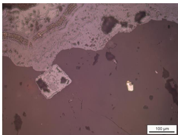
Figura 5. 6 - Fotomicrografia de luz refletida de amostra do filão (VEL-08a), na qual pirita (creme) ocorre em ganga (quartzo, cinza escuro), cujo contato com goethita coloforme (cinza claro) é sinuoso. Nota-se pseudomorfo de goethita a partir de provável pirita.
