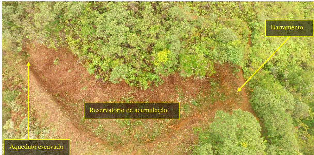
Figura 5.36 – Vista aérea do reservatório de acumulação localizado no final do aqueduto do Xéu-1. Foto: Rolling Drones Geotecnologias.
