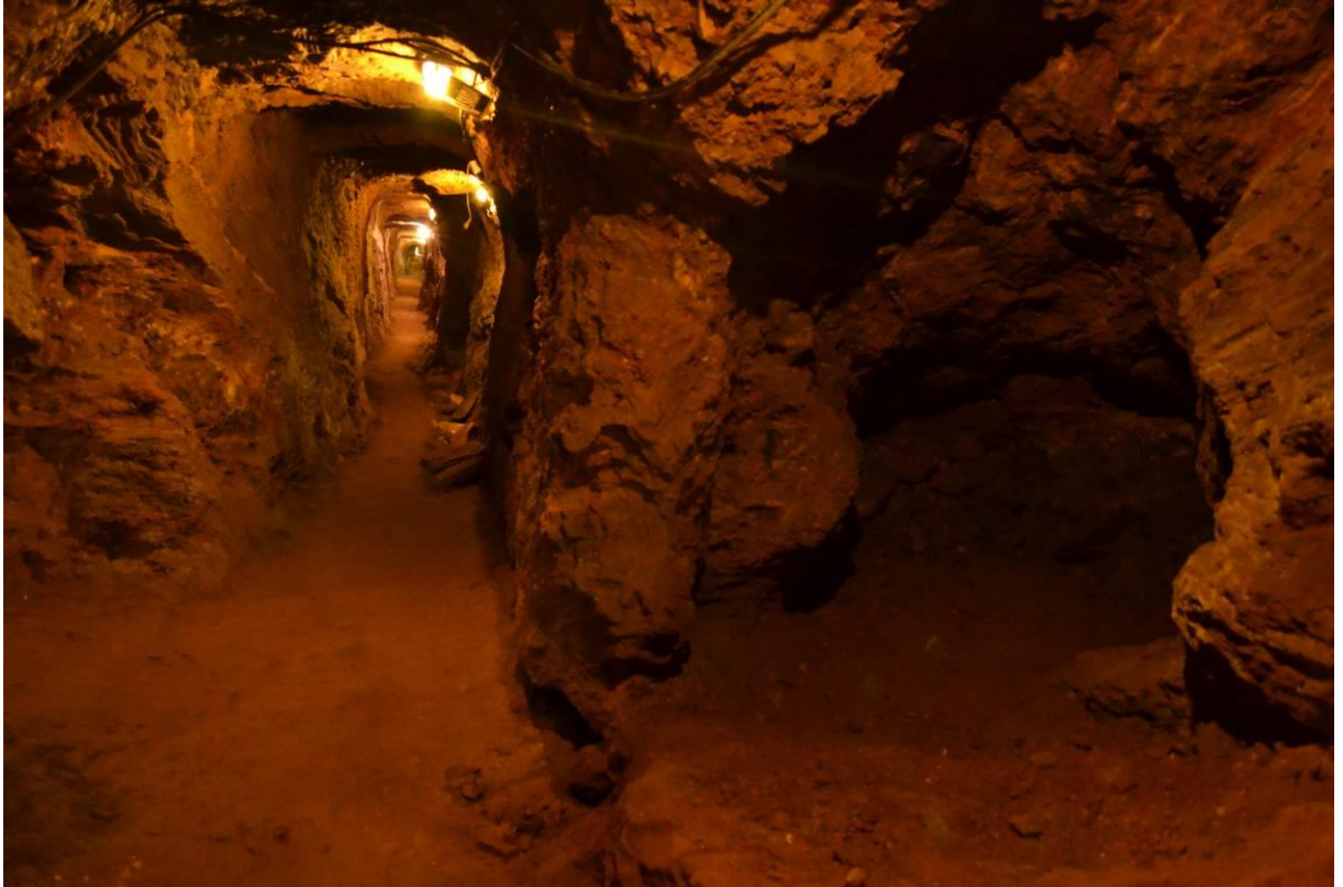
Figura 5.8 - Interior da Mina Du Veloso. Nota-se os grandes vãos (câmaras) com pilares de sustentação.
