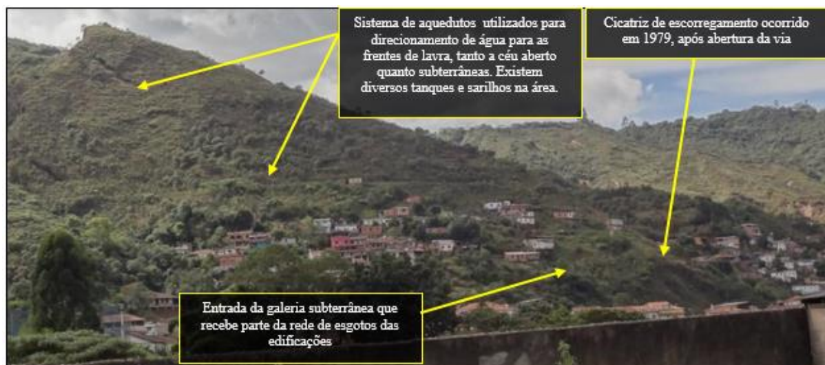
Figura 2.16 Trecho do bairro São Cristóvão que demanda maiores estudos geotécnicos devido às condicionantes geológicas e intervenções antrópicas realizadas nos últimos 300 anos.
