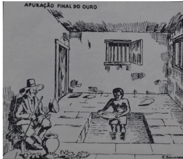
Figura 5.38 - Fossa de purificação final do ouro (Eschwege 1979).
