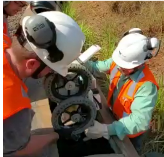
(b) EspeleoRobô sendo inserido pela janela
