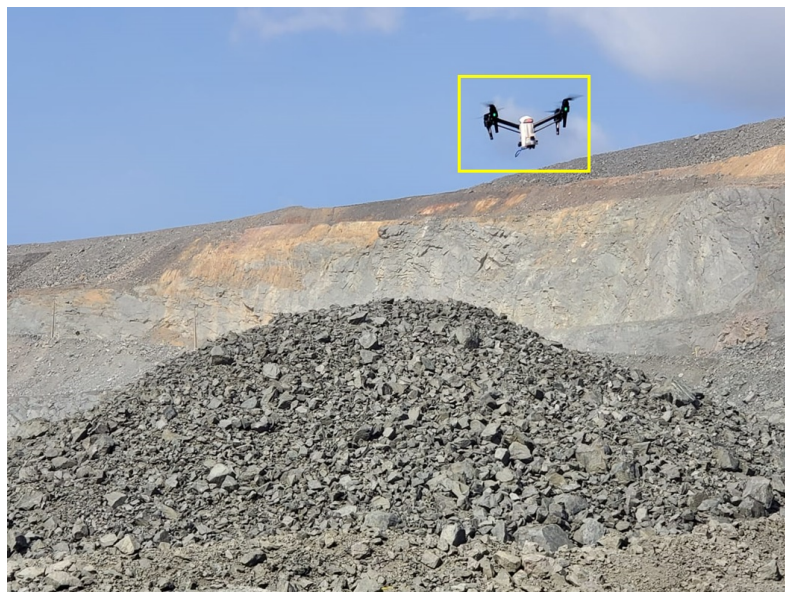
Figura 3.10: Voo automatizado sobre material detonado. Caixa amarela apresentando foco no drone em voo.
