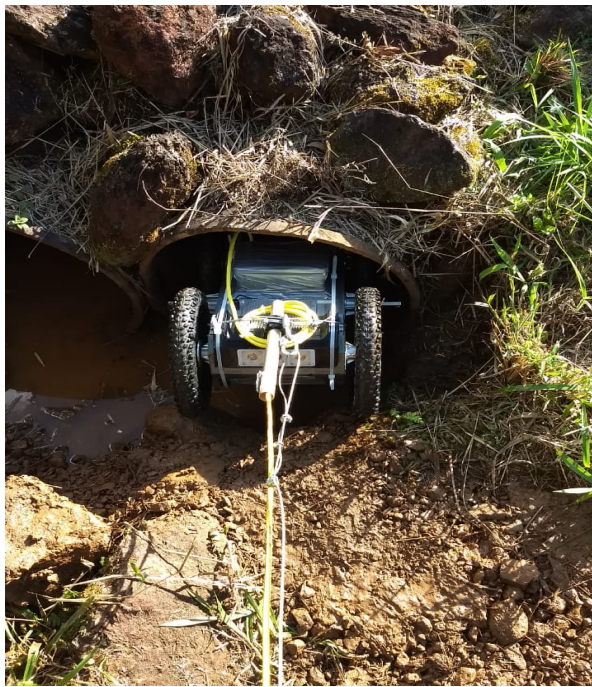
(a) Inspeção de tubulação da barragem de água da Mina do Fazendão
