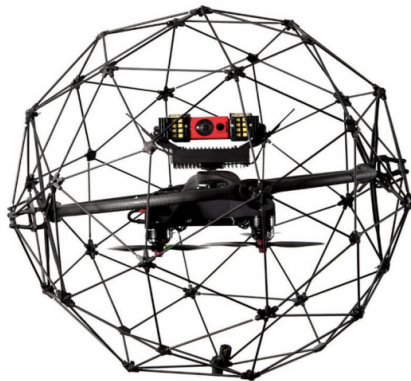
(c) Drone utilizado para inspeção de ambientes confinados
