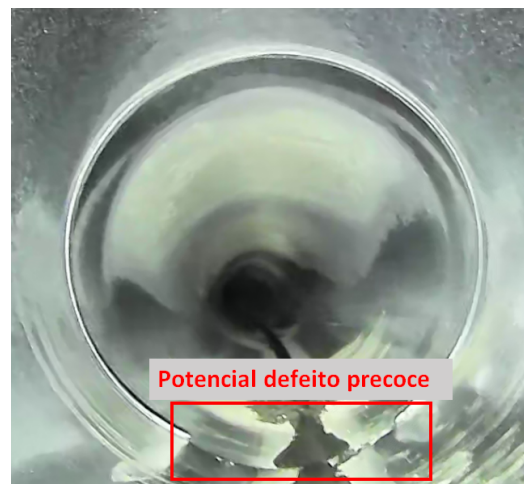
(b) Junta com potencial defeito precoce, devido à descontinuidade na parte inferior
