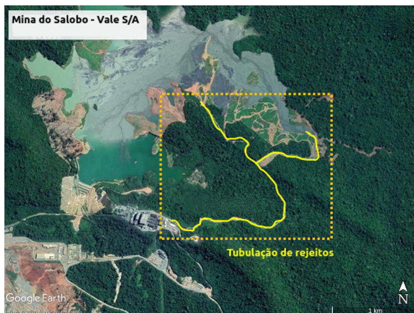
Figura 5.1: Vista superior da Mina do Salobo. A linha em amarelo destaca a tubulação.
