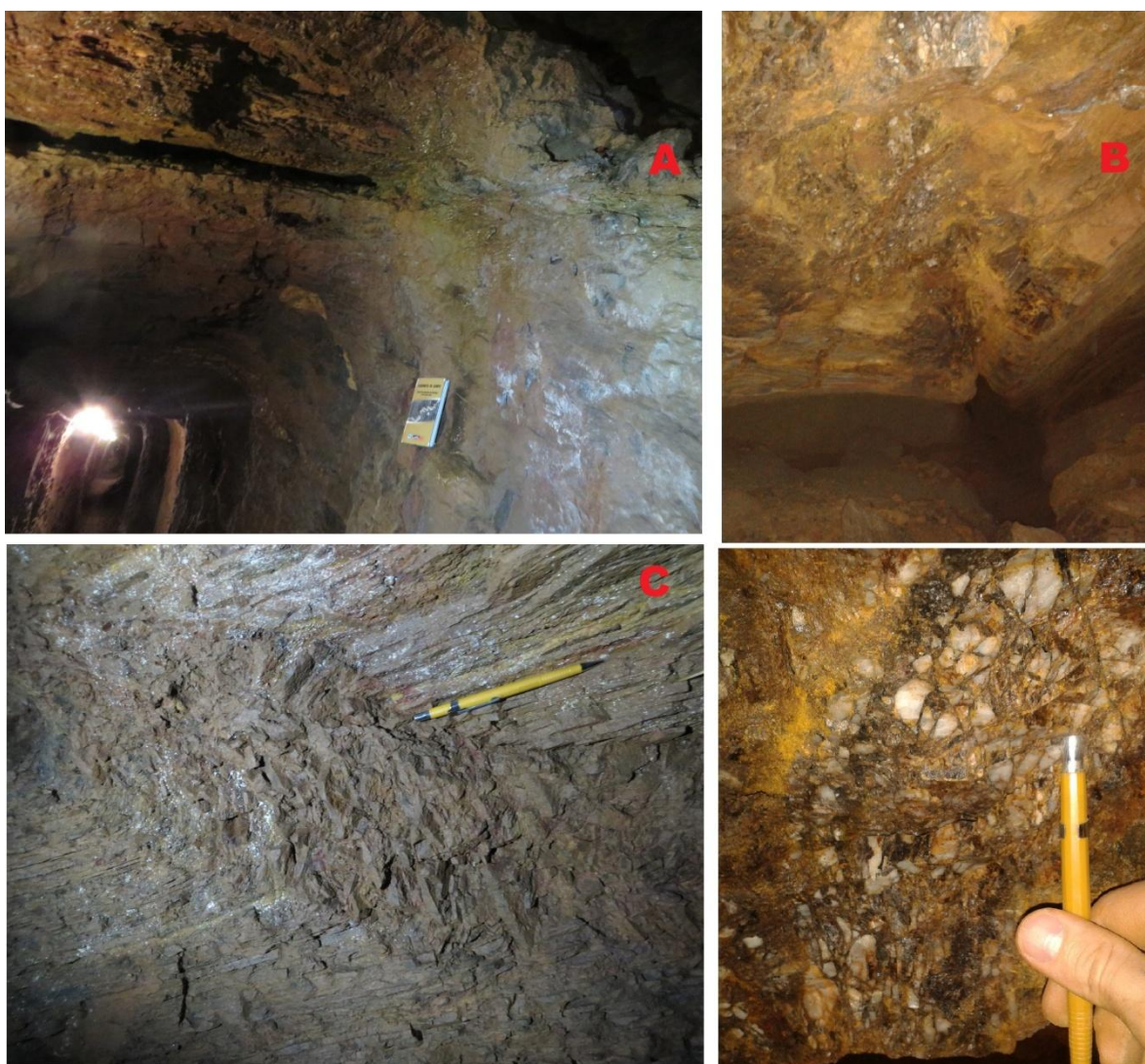
Figura 4.8: A) Falha 1 e percolação de água em rocha argilosa. B) Falha 2, brecha de falha. C) Falha 3, brecha de falha em zona de cisalhamento.
