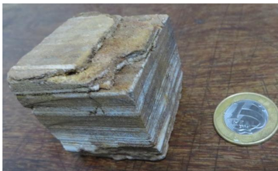
Figura 4.2: Amostra de "Itabirito Xistoso" retirada da mina e serrada em laboratório.
