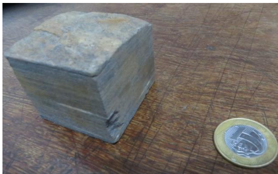
Figura 4.1: Amostra de "Itabirito Compacto" retirada da mina e serrada em laboratório.
