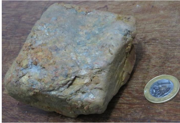
Figura 4.3: Amostra de "Filito prateado" retirada da mina e serrada em laboratório.
